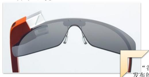
"谷歌眼镜"是谷歌公司在2012年4月 发布的一款"扩展现实"眼镜产品,可以 通过声音控制拍照、视频通话和辨明方向, 可以访问互联网信息,可以处理文字信息 和电子邮件。眼镜的右眼镜片上安装了一 个微型投影仪和一个摄像头,投影仪用以 显示数据,摄像头用来拍摄视频和照片, 再通过传感器进行存储和传输,而操控模 式可以是语言或触控。
